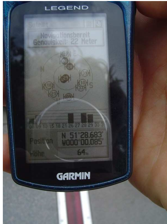
Source: Wikipedia.de, “Ein GPS-Empfänger zeigt über dem in Greenwich markierten Nullmeridian nicht exakt die Länge Null an”, https://de.wikipedia.org/wiki/Nullmeridian#/media/File:Greenwich-GPS.jpg , Retrieved 1-Oct-2018
